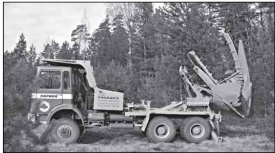
Вот такой ковш нужен, чтобы вырыть конусообразную яму, в которой будет комфортно взрослому дереву
